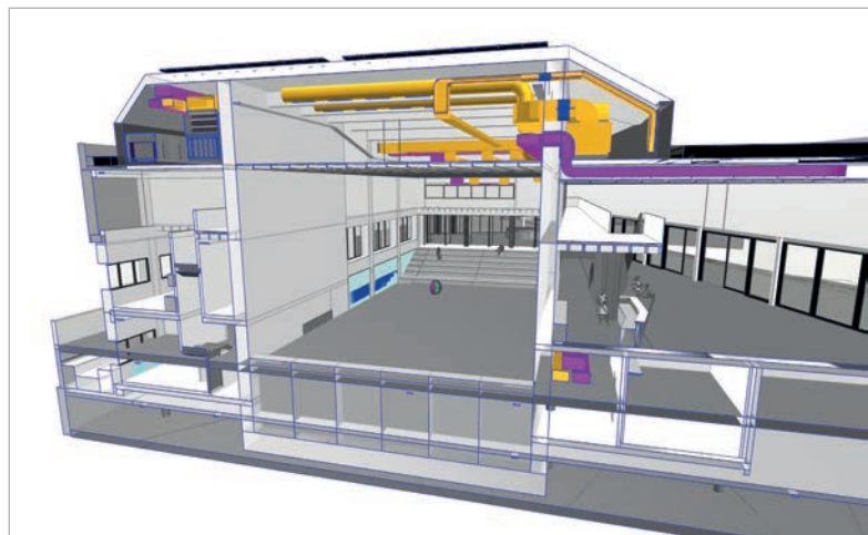
3D-Darstellung TGA-Planung des Neubaus Kammerspiele Ingolstadt
